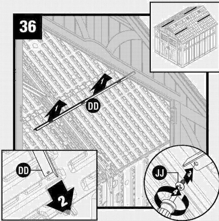
Levante la barra de soporte del techo (DD) hasta su posición contra el techo. Deslice la barra de soporte del techo (DD) en el dintel frontal. Asegure la barra de soporte del techo (DD) debajo del tramo de la cabriada con un tornillo (JJ).
