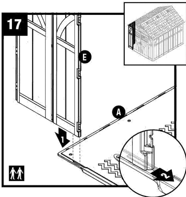
Alinee la lengüeta en el lado inferior de la esquina delantera izquierda (E) con la ranura en el piso izquierdo (A). Introduzca el panel dentro de la ranura y trábelo haciendo deslizar el panel hacia la abertura de la puerta.
