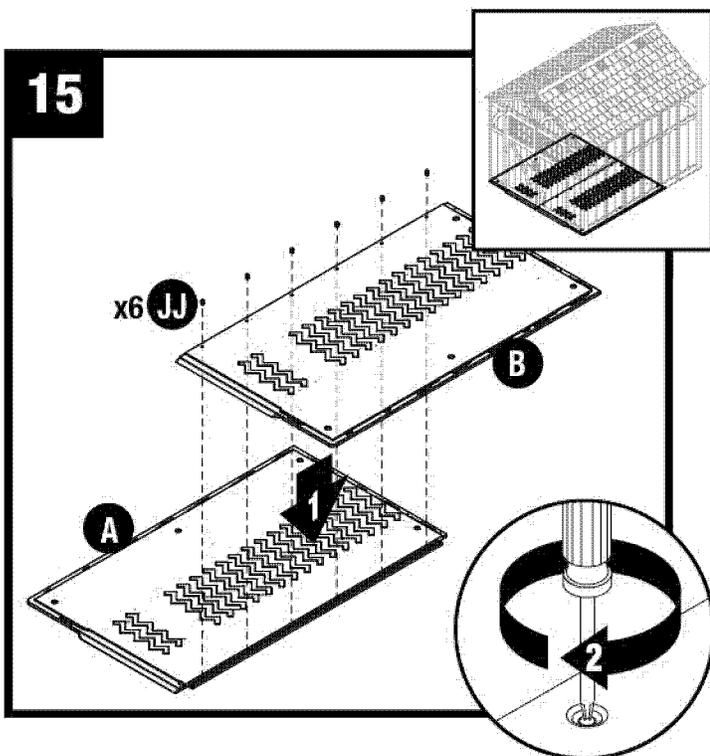
Empuje simultáneamente los paneles del piso izquierdo (A) y del piso derecho (B), y asegure con seis tornillos (JJ).
