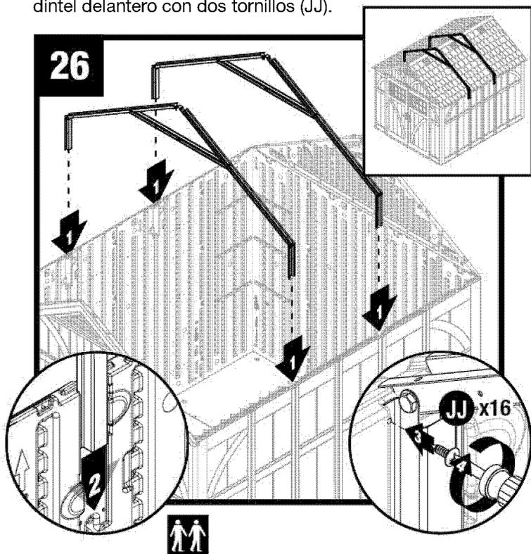
Deslice los ensambles de la cabriada en el lugar apropiado. Asegure con cuatro tornillos (JJ) en cada soporte del adaptador lateral.
