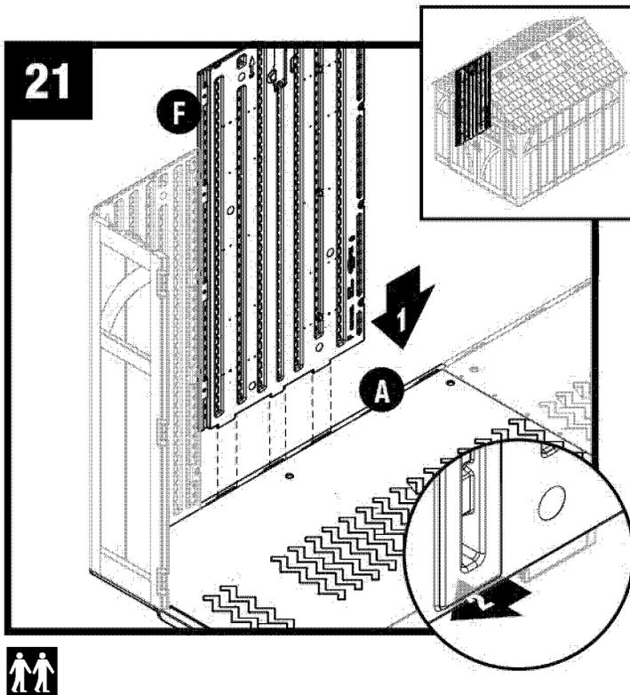
Alinee las pestañas en la parte inferior del panel lateral (F) con las ranuras a lo largo del piso (A). Introduzca el panel dentro de las ranuras y trábelo haciendo deslizar el panel hacia la esquina delantera.
