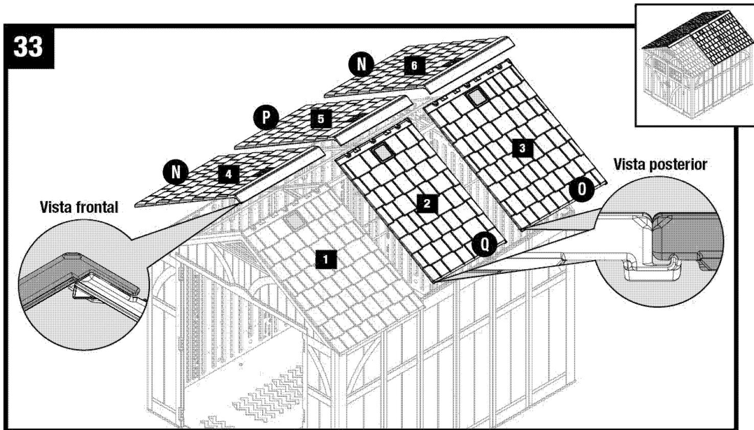
Repita los pasos 30 a 32 con los paneles de techo restantes. Instale los paneles en el orden que se muestra. **En este punto, apriete completamente todo el hardware.**
