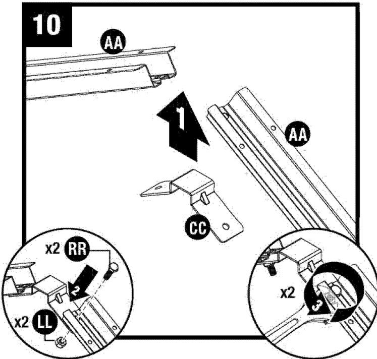
Ajuste el soporte de la cabriada (CC) en la esquina del tramo de la cabriada (AA) con un tornillo de cabeza hexagonal (RR) y una tuerca (LL).
