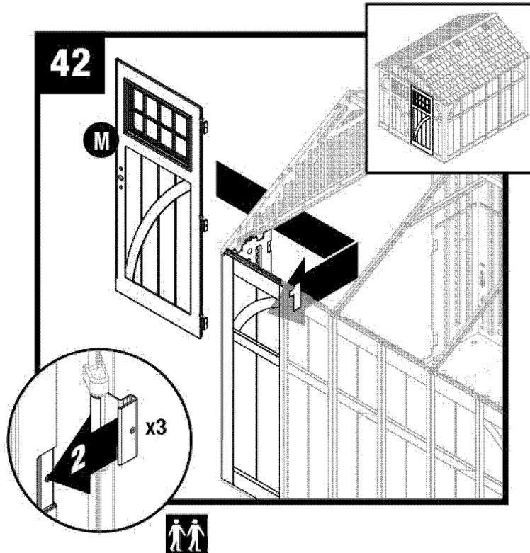
Con la bisagra de la puerta en la posición abierta, deslice la bisagra de la puerta sobre cada receptáculo de bisagra en el interior del panel frontal derecho.
