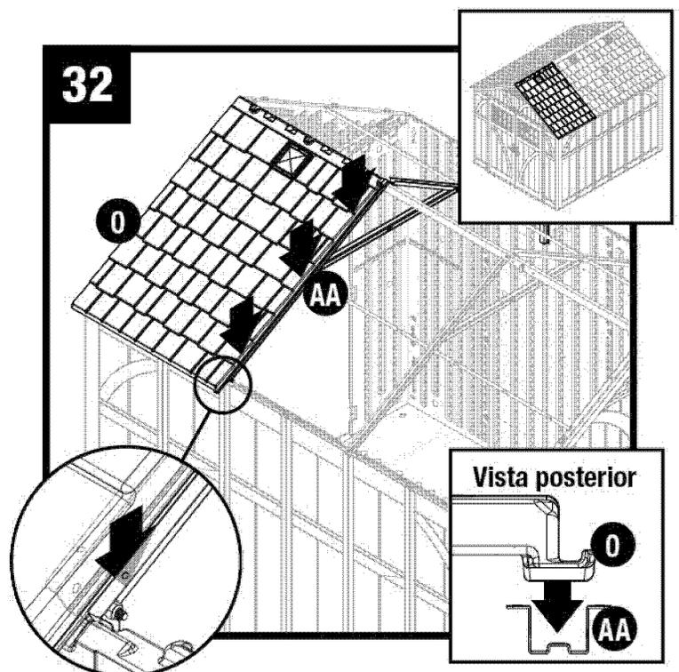
Presione el borde del panel de techo derecho (O) dentro del canal del tramo de la cabriada (AA).
