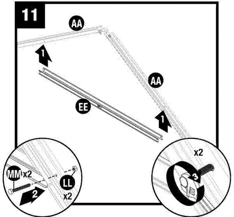
Ajuste dos vigas transversales de cabriada (EE) a dos tramos de la cabriada (AA) con dos tornillos de cabeza hexagonal (MM) y dos tuercas (LL). Erija la cabriada y verifique que la viga transversal esté nivelada.
