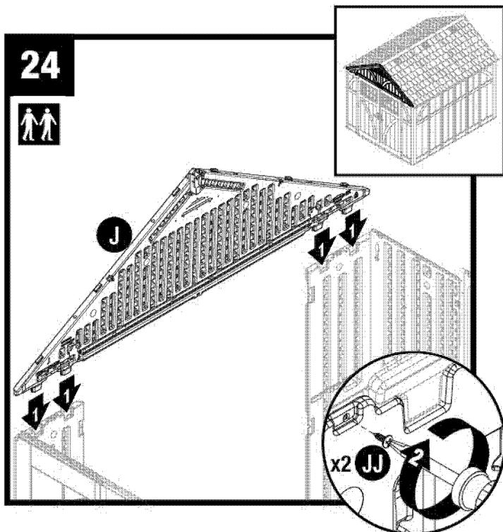
Coloque el dintel delantero (J) sobre la abertura de la puerta e instale las cuatro bases de apoyo sobresalientes en los receptáculos moldeados en las esquinas delanteras. Ajuste el dintel delantero con dos tornillos (JJ).
