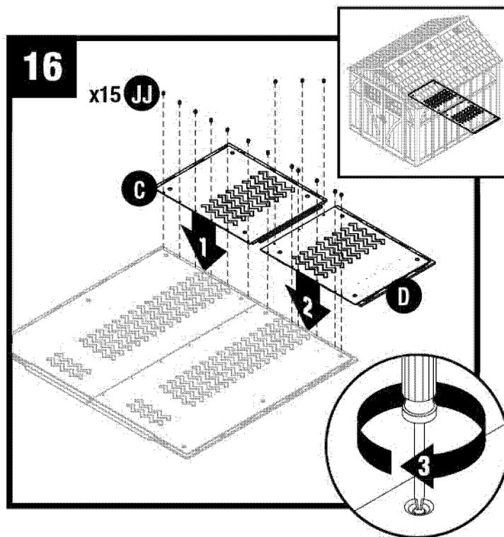
Repita el Paso 15 para la extensión del piso izquierdo (C) y la extensión del piso derecho (D). Asegúrelo con 15 tornillos.
