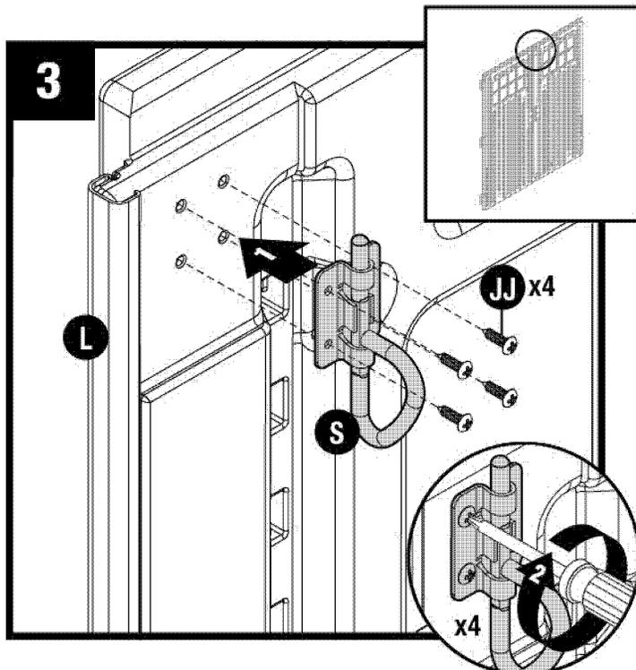
Sujete el perno deslizante del anillo en D (L) en el lado interior superior de la puerta izquierda (S) con cuatro tornillos (JJ).
