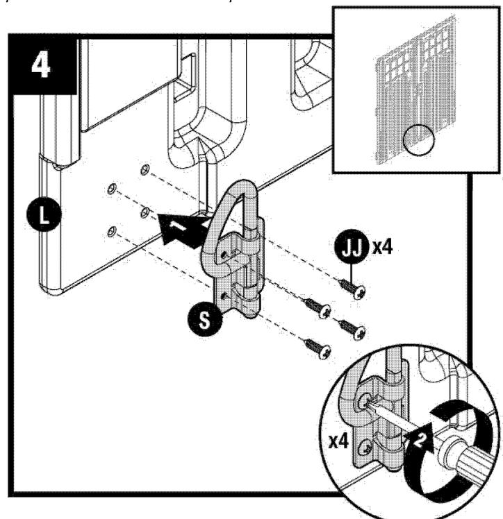
Sujete el perno deslizante del anillo en D (L) en el lado interior inferior de la puerta izquierda (S) con cuatro tornillos (JJ).
