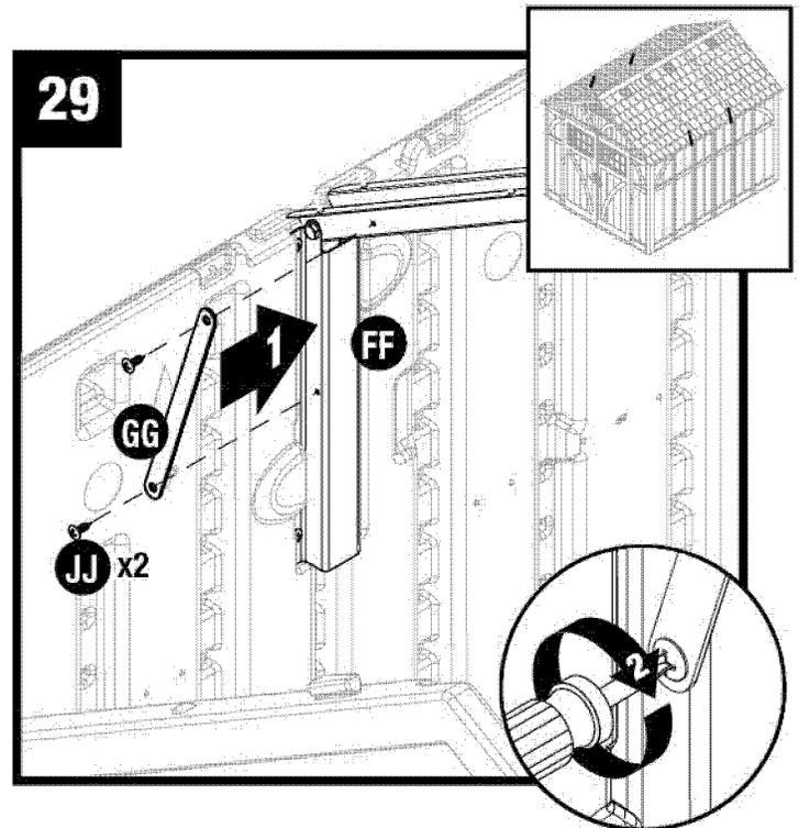
Fije un tirante de cabriada (GG) al soporte del adaptador lateral (FF) con dos tornillos (JJ).
