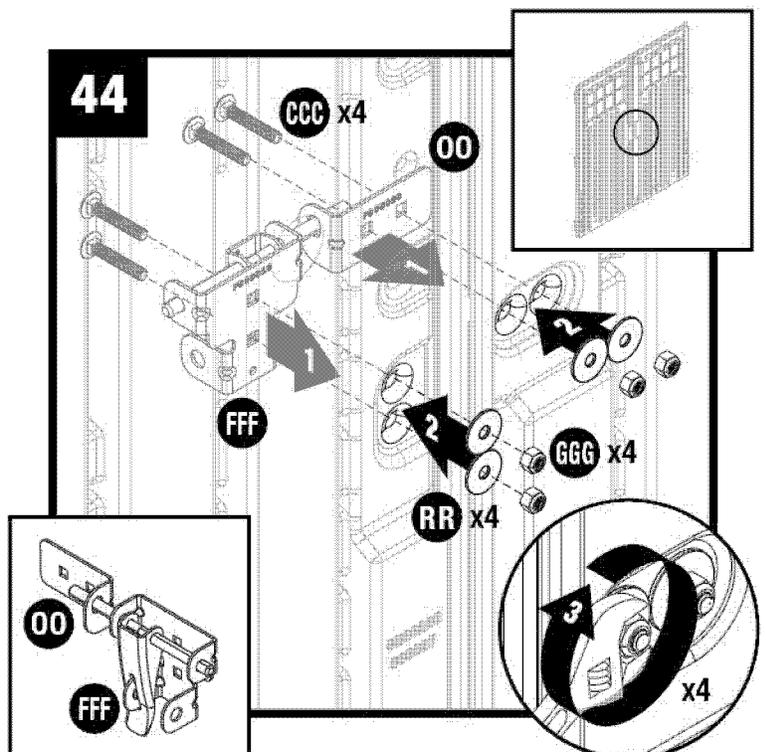
Inserte dos tornillos (CCC) en la placa izquierda del pestillo (FFF) y a través de los orificios perforados previamente en las puertas. Mientras sostiene la placa en su lugar en la puerta exterior, asegúrela con dos arandelas (RR) y dos tuercas de bloqueo (GGG). Repita lo mismo para la placa derecha del pestillo (FFF).
