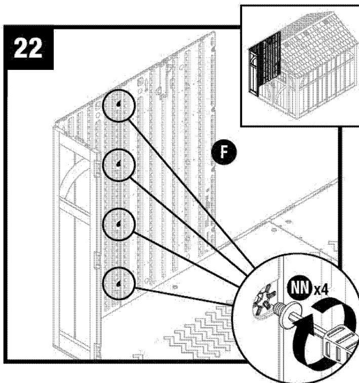
Ajuste el panel lateral (F) con cuatro pernos “Easy Bolt” (NN), trabajando desde el piso hacia el techo. **NO** use una llave de torsión. Use la herramienta Easy Driver (OO) para pernos y apriete manualmente. La cabeza del perno “Easy Bolt” quedará al ras cuando esté completamente asentado. **NO** apriete demasiado los pernos “Easy Bolt”.
