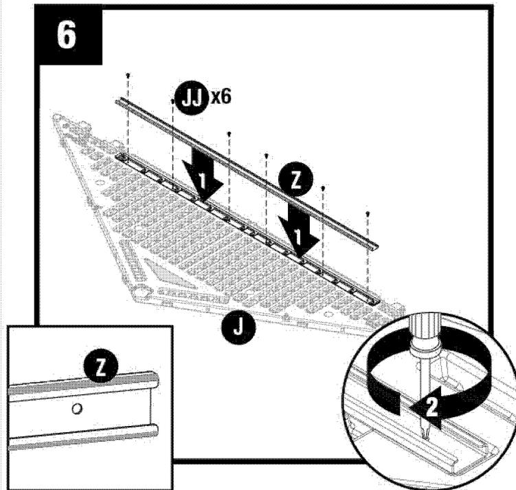
Coloque una viga del dintel (Z) dentro del receptáculo del dintel delantero (J). Asegure con seis tornillos (JJ). **NO** apriete demasiado los tornillos.
