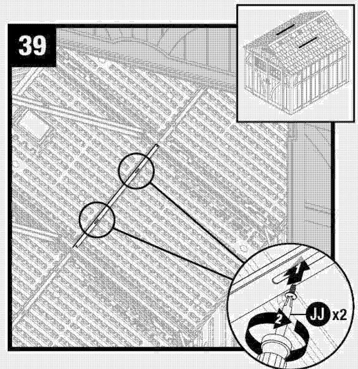
Asegure la extensión de soporte del techo (BB) al panel interno del techo usando dos tornillos (JJ).
