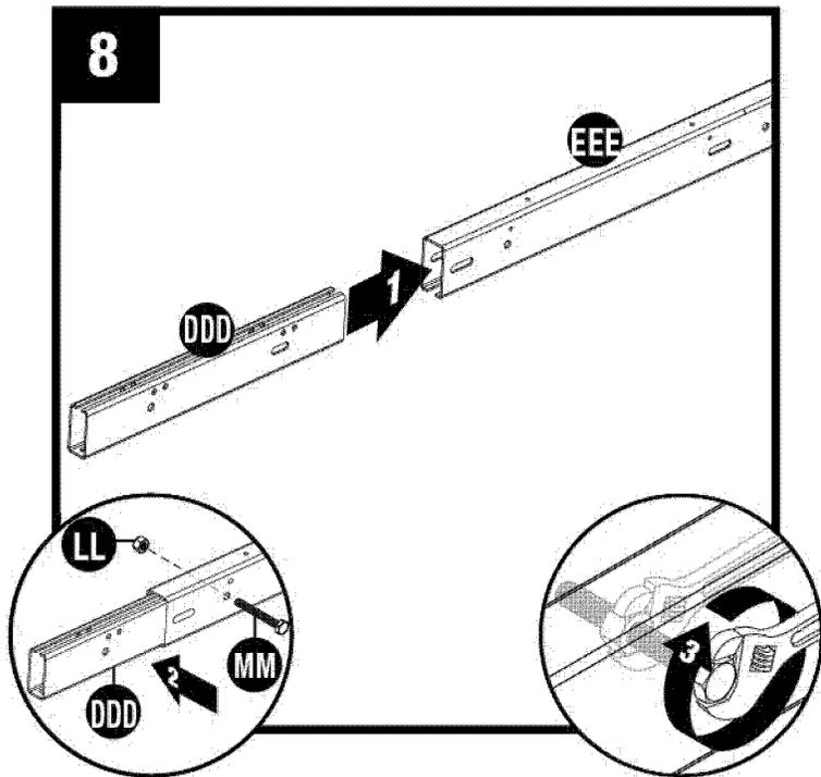
Coloque carpintero viga cumbrera ( DDD ) en viga cumbrera 3 ' (EEE). Asegure con el perno hexagonal (MM) y la tuerca ( LL ) .
