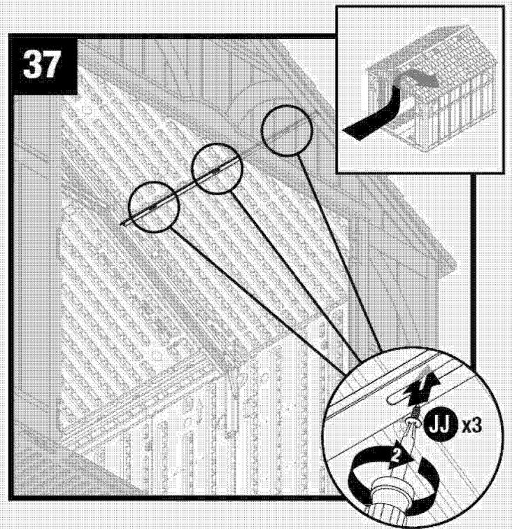
Ajuste el soporte del techo al techo con tres tornillos (JJ).
