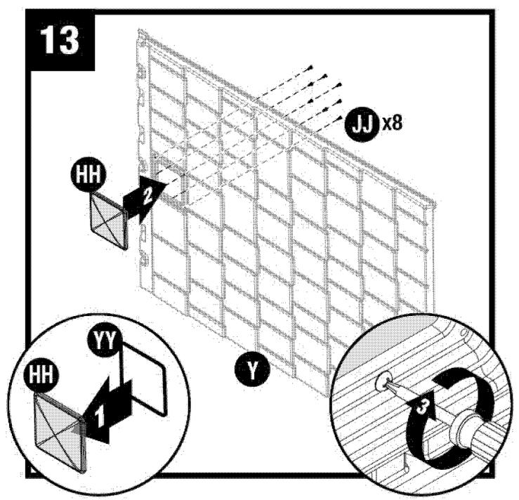
Coloque el empaque del tragaluz (YY) en el tragaluz (HH). Coloque el tragaluz (HH) en el panel de techo derecho (O). Ajuste por debajo con ocho tornillos (JJ). Asegúrese de que la varilla en las partes plásticas esté completamente asentada contra el empaque en el tragaluz.
