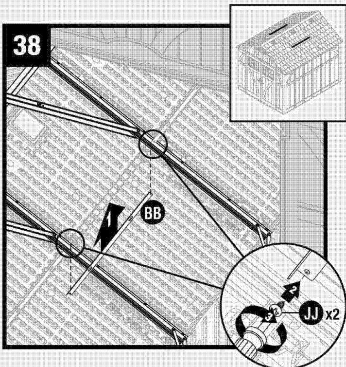
Sujete la extensión de soporte del techo (BB) a los tramos de la cabriada con un tornillo (JJ), en cada lado.
