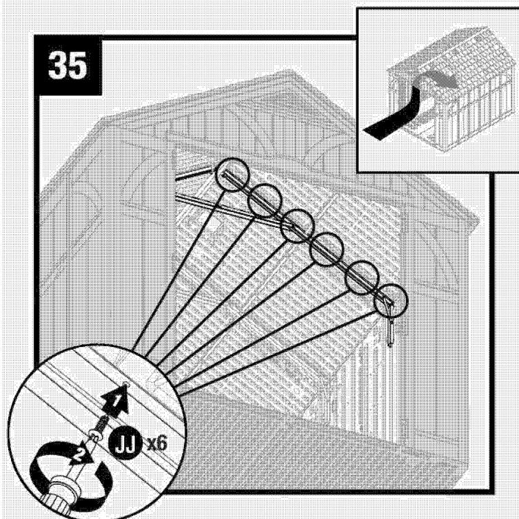
Tire de cada esquina inferior del techo hacia abajo desde el exterior. Desde adentro del cobertizo, ajuste las pestañas del panel de esquina delantero derecho (I) y el panel del techo (F) del panel lateral con cuatro tornillos (JJ).
