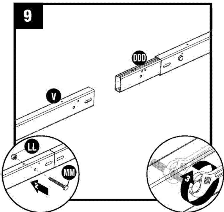
Coloque la viga cumbrera de 2,13 m (7 pies) (V) en la unión de la viga cumbrera (DDD). Asegúrela con un perno hexagonal (MM) y una tuerca (LL).
