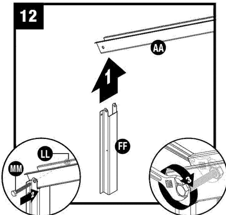
Ajuste el soporte del adaptador lateral (FF) en el extremo del tramo de la cabriada izquierda (AA) con un tornillo de cabeza hexagonal (MM) y una tuerca (LL).
