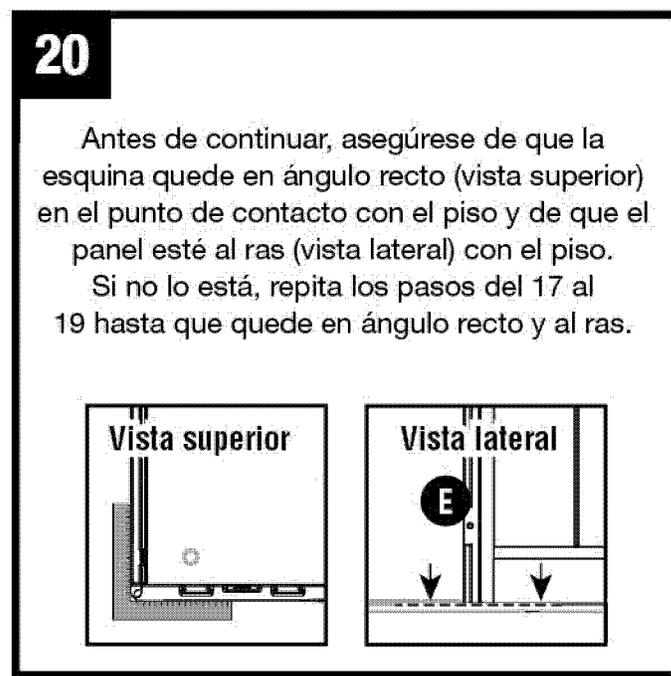
Antes de continuar, asegúrese de que la esquina quede en ángulo recto (vista superior) en el punto de contacto con el piso y de que el panel esté al ras (vista lateral) con el piso.
