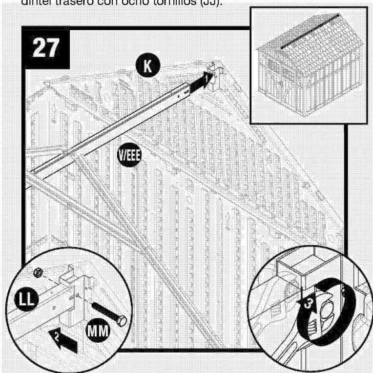
Levante la viga cumbre (V/EEE) e introdúzcala en el dintel trasero (K). Asegure con un tornillo (MM) y una tuerca (LL). No los apriete. Repita este paso para el dintel delantero (J).
