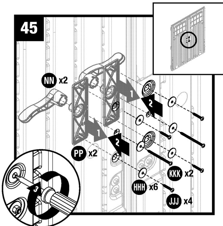
Desde el exterior de las puertas, inserte las manijas de las puertas (NN) en las placas de las manijas (PP). En el interior de las puertas, coloque las arandelas (HHH) en el lugar para las manijas de las puertas centrales y asegure cada manija (NN) con un tornillo largo (KKK).
