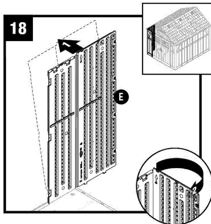
Incline levemente hacia fuera el panel de esquina delantero izquierdo (E) y doble la bisagra de la esquina.
