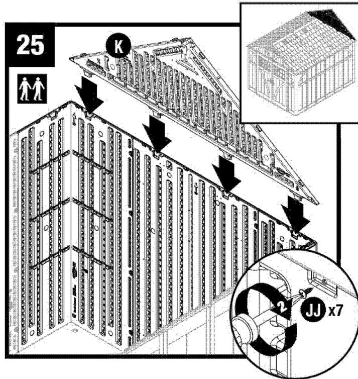
Coloque el dintel trasero (K) sobre las paredes traseras e instale las cuatro bases de apoyo sobresalientes en los receptáculos moldeados en las paredes traseras. Ajuste el dintel trasero con ocho tornillos (JJ).
