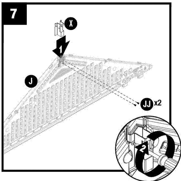
Deslice el soporte viga cumbre (X) bajo lengüetas dentro pico de cabecera frontal (J) y seguro con dos tornillos (JJ). No apriete demasiado los tornillos.
