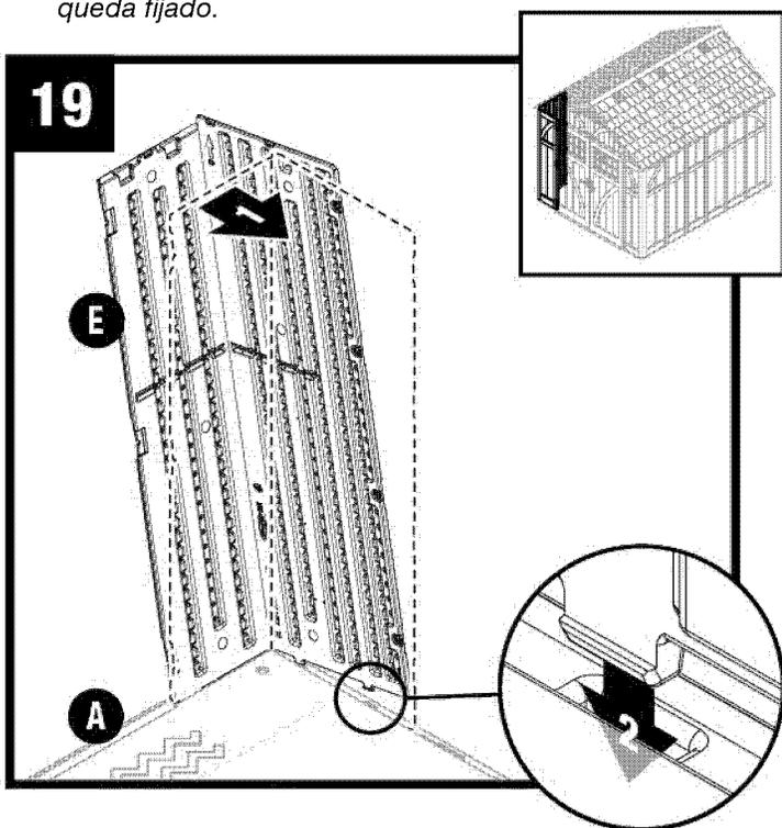
Incline la esquina delantera izquierda (E) nuevamente a la posición vertical y alinee las lengüetas inferiores del lado derecho con las ranuras del piso.
