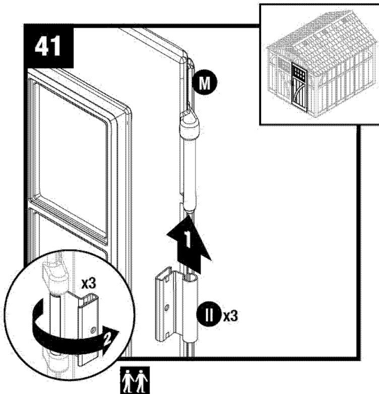
Coloque en forma vertical la puerta derecha (M) con los tres montajes para las bisagras orientados hacia la derecha. Deslice una bisagra de metal (II) de la puerta sobre cada montaje para bisagra. Gire las bisagras de la puerta hacia la parte externa de la puerta.
