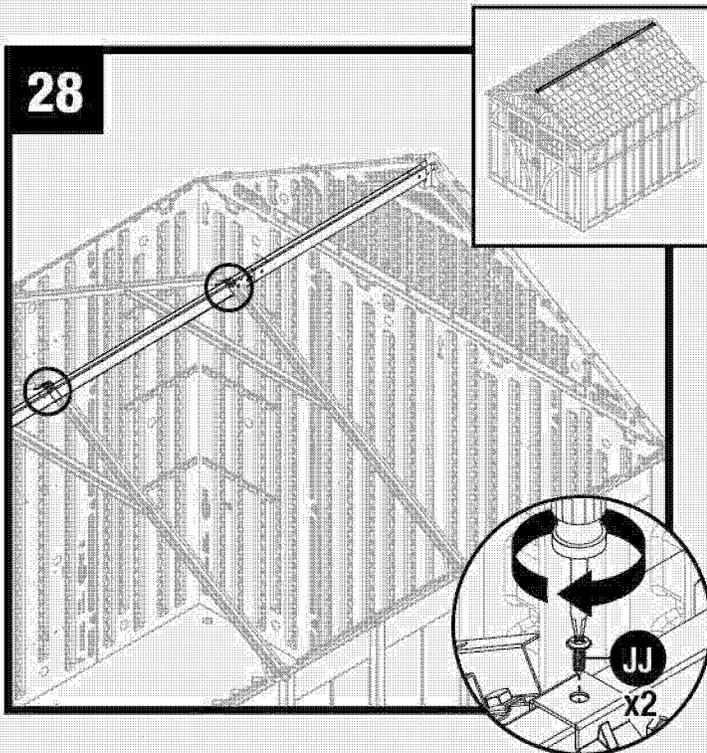
Fije el ensamble de la cabriada de techo a la viga cumbrera con dos tornillos (JJ).
