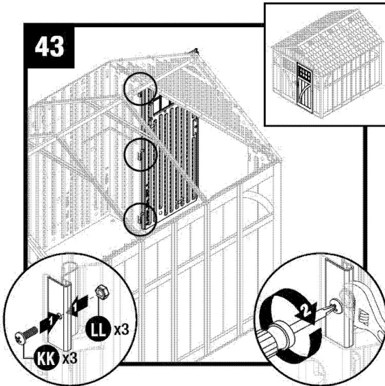
Asegure cada placa de bisagra de metal con un tornillo (KK) y una tuerca (LL).
