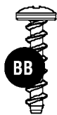
BB Vis à tête cylindrique bombée n° 8 x 3/4 po. / Tornillo de cabeza abombada n° 8 x 3/4 pulg. x1
