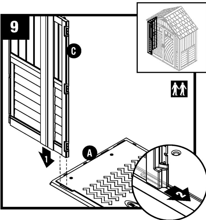
Alinee la pestaña en el lado inferior derecho del panel delantero izquierdo (C) con la ranura en el piso delantero (A). Introduzca el panel dentro de la ranura y trábelo haciendo deslizar el panel hacia la abertura de la puerta.
