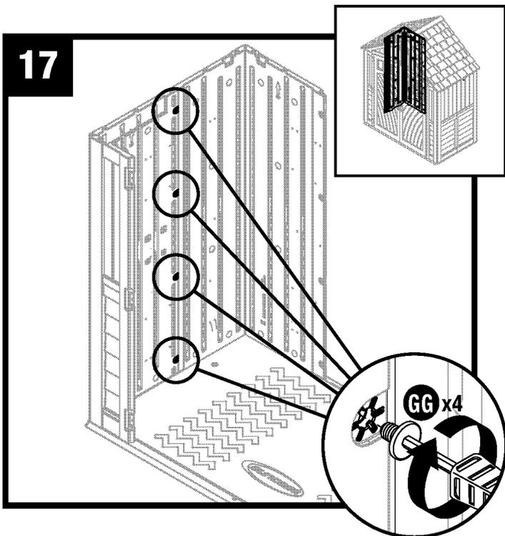
Ajuste la esquina trasera con cuatro pernos Easy Bolt (GG). Avance desde el piso hacia el techo. **NO** use una llave de torsión. Use la herramienta Easy Driver (XX) para pernos Easy Bolt y apriete manualmente. La cabeza del perno "Easy Bolt" estará al ras cuando esté completamente asentado. **NO** apriete demasiado los pernos "Easy Bolt".
