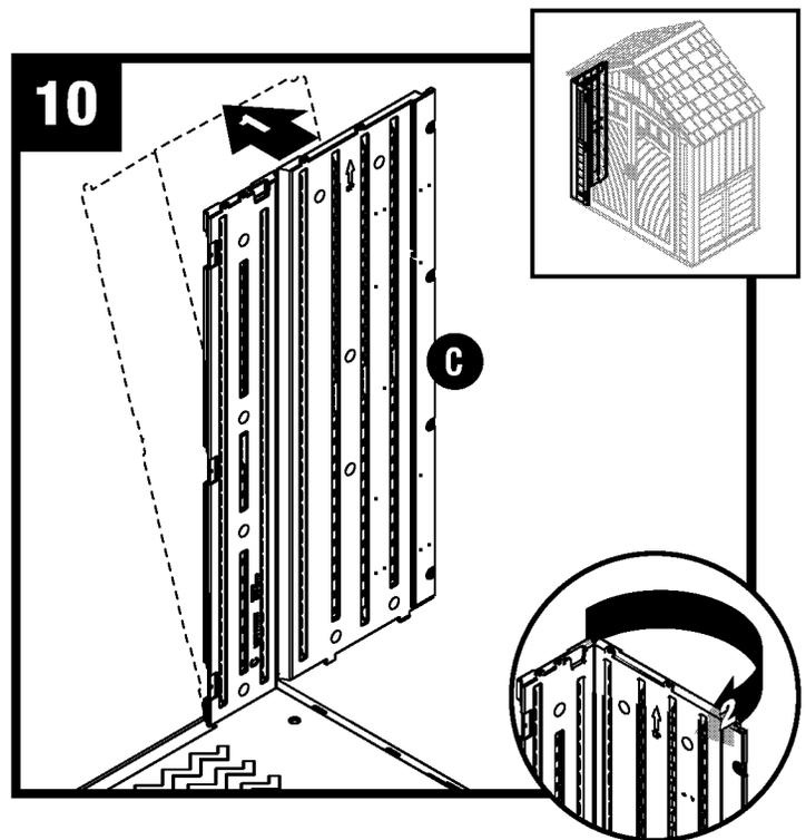
Incline levemente hacia fuera el panel delantero izquierdo (C) y doble la bisagra de la esquina.
