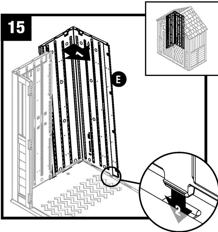
Incline el panel de esquina trasero (E) nuevamente hacia la posición vertical y alinee las pestañas inferiores ubicadas del lado izquierdo con las ranuras del piso.
