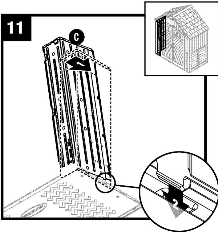
Incline el panel delantero izquierdo (C) nuevamente hacia la posición vertical y alinee las pestañas inferiores ubicadas en el lado derecho con las ranuras del piso.
