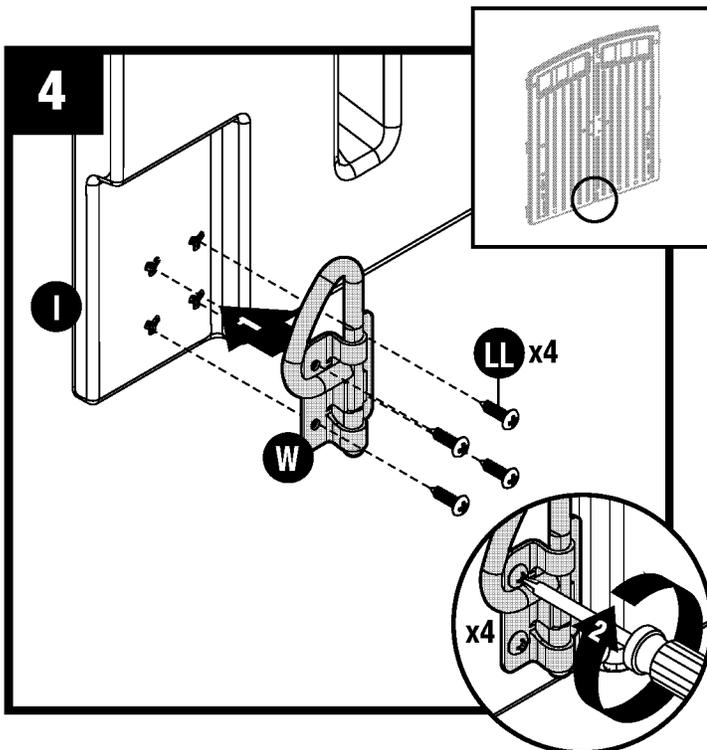
Sujete el perno deslizante del anillo en D (W) en el lado interior inferior de la puerta izquierda (I) haciendo pasar cuatro tornillos (LL) por los orificios provistos.
