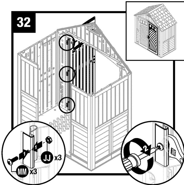
Ajuste cada placa de la bisagra de metal con un tornillo (MM) y una tuerca (JJ).
