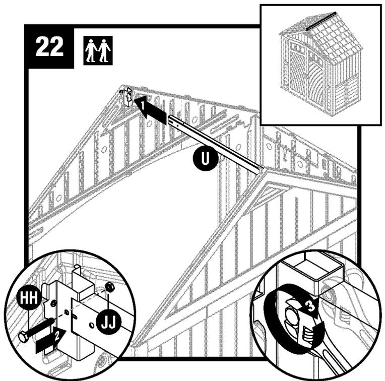
Deslice la viga cumbre (U) en el soporte de la viga cumbre del techo delantero. Ajuste con un tornillo de cabeza hexagonal de 2" (HH) y una tuerca (JJ).
