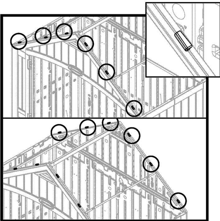
Antes de continuar, ubique e identifique las seis pestañas del dintel delantero y la seis pestañas del dintel trasero.
