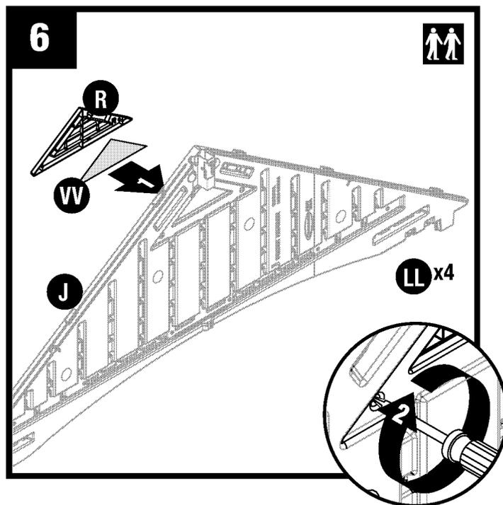
Coloque la rejilla de ventilación de fibra de vidrio (VV) y la ventilación del dintel (R) en la abertura delantera del dintel delantero (J). Asegure con cuatro tornillos (LL) la parte trasera del dintel. **NO** apriete demasiado los tornillos.
