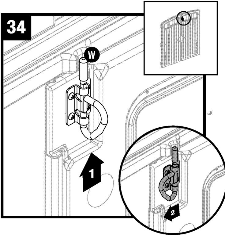
Empuje el anillo D (E) hacia arriba para enganchar con la ranura en el cabezal. Gire el anillo D hacia la izquierda a la posición de cerrado.
