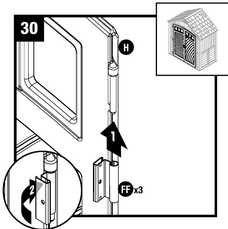
Levante la puerta derecha (H) con los tres montajes para las bisagras orientadas hacia la derecha. Deslice una placa de bisagra de metal (FF) sobre cada montaje para bisagra. Gire las placas de bisagra hacia la parte externa de la puerta.
