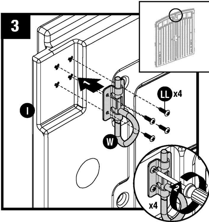
Sujete el perno deslizante del anillo en D (W) en el lado interior superior de la puerta izquierda (I) haciendo pasar cuatro tornillos (LL) por los orificios provistos.
