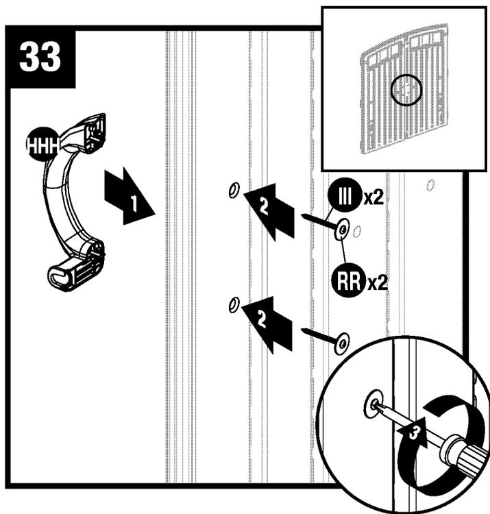
Coloque la manija de la puerta (HHH) a la izquierda de la puerta con dos tornillos (III) y dos arandelas (RR). Repita para puerta derecha.
