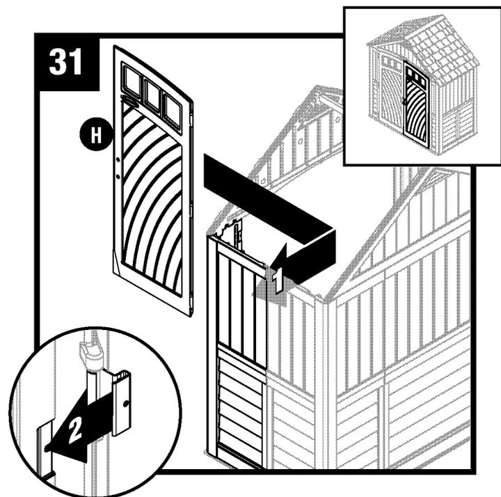
Rote las placas de bisagra de metal a la posición abierta. Deslice una placa de bisagra de metal sobre cada receptor de bisagra en el interior del panel frontal derecho.
