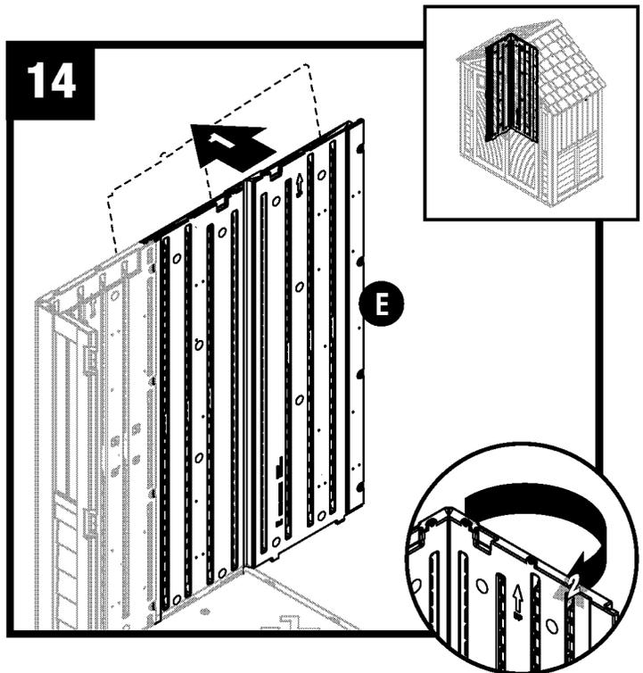
Incline levemente hacia fuera el panel de esquina trasero (E) y doble la bisagra de la esquina.
