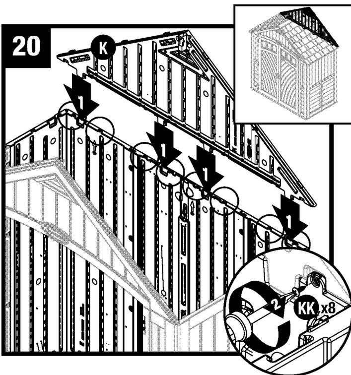
Coloque el dintel trasero (K) sobre las paredes traseras e instale las dos patas de apoyo sobresalientes en los receptáculos moldeados en las paredes traseras. Ajuste el dintel trasero con ocho tornillos (KK).
