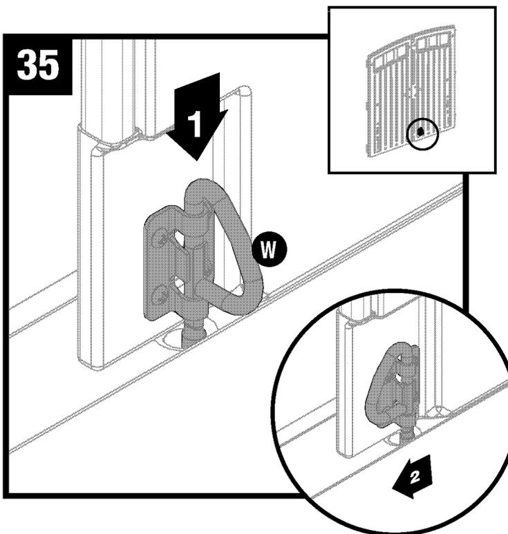
Empuje el anillo D (E) hacia abajo para enganchar con el agujero en el piso. Gire el anillo D hacia la izquierda a la posición de cerrado.
