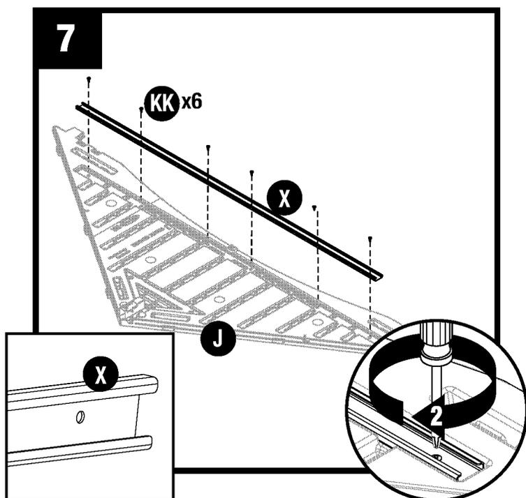
Apoye el dintel (J) en el suelo con el lado que tiene las letras hacia arriba. Coloque una viga del dintel (X) dentro del receptáculo del dintel delantero (J). Ajuste con seis tornillos (KK). **NO** apriete demasiado los tornillos.
