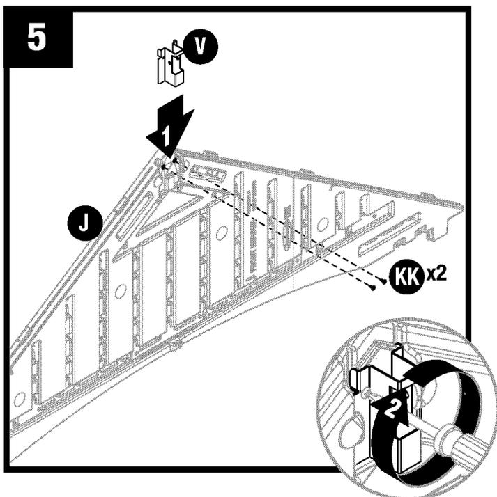
Deslice el soporte de la viga cumbre del techo (V) debajo de las pestañas en el interior de la cima del dintel delantero (J) y ajústelo con dos tornillos (KK). **NO** apriete demasiado los tornillos.
