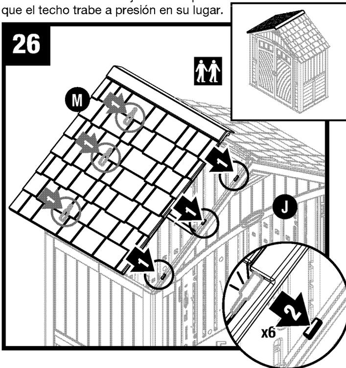
Coloque techo izquierda (M) directamente sobre las tres fichas en el lado izquierdo de la cabecera frontal (J). Con ranuras del techo izquierda sentados sobre / en las pestañas de cabecera, comprobar la alineación en los tres puntos. Deslice techo izquierda (M) hacia el exterior del galpón. Escuchará un "chasquido" cuando se ejecutan.
