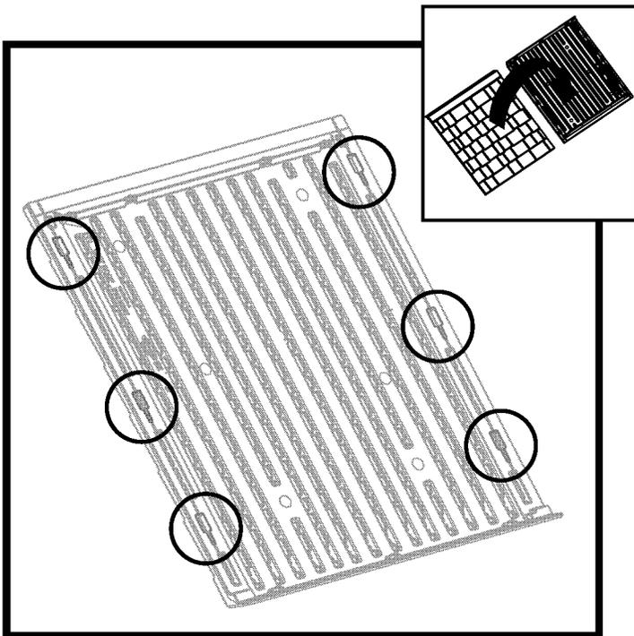
Antes de continuar, ubique e identifique los canales en el lado interior del techo del lado derecho (L) y del izquierdo (M). Ubique las tres pestañas inferiores que están dentro de cada canal.
