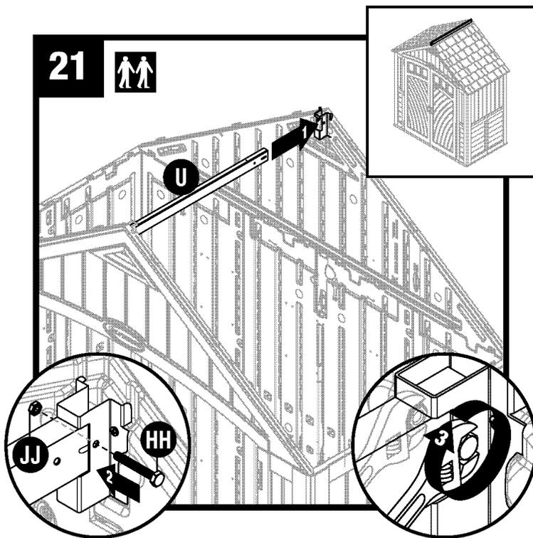
Erija la viga cumbre (U) y colóquela en el soporte de la viga cumbre del techo trasero. Ajuste con un tornillo de cabeza hexagonal de 2" (HH) y una tuerca (JJ).
