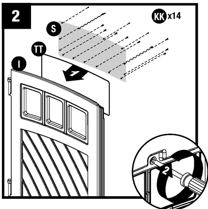
Capa en el canal de la puerta, la junta de la ventana de la puerta (TT) y la ventana de la puerta (S). Asegure las capas a través de la parte posterior de la puerta con 14 tornillos (XX) (comience con cuatro tornillos de esquina y luego termine con los tornillos restantes). **NO** apriete demasiado los tornillos. Repita los pasos 1 y 2 para la puerta derecha (H).
