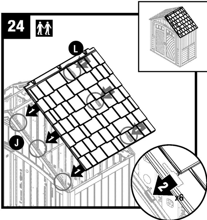
Coloque el panel de techo derecho (L) directamente sobre las tres pestañas en el lado derecho del dintel delantero (J). Con el canal del panel de techo del lado derecho asentado sobre las pestañas del dintel, tire del panel de techo del lado derecho hacia abajo en cada pestaña del dintel hasta que el techo trabaje a presión en su lugar.
