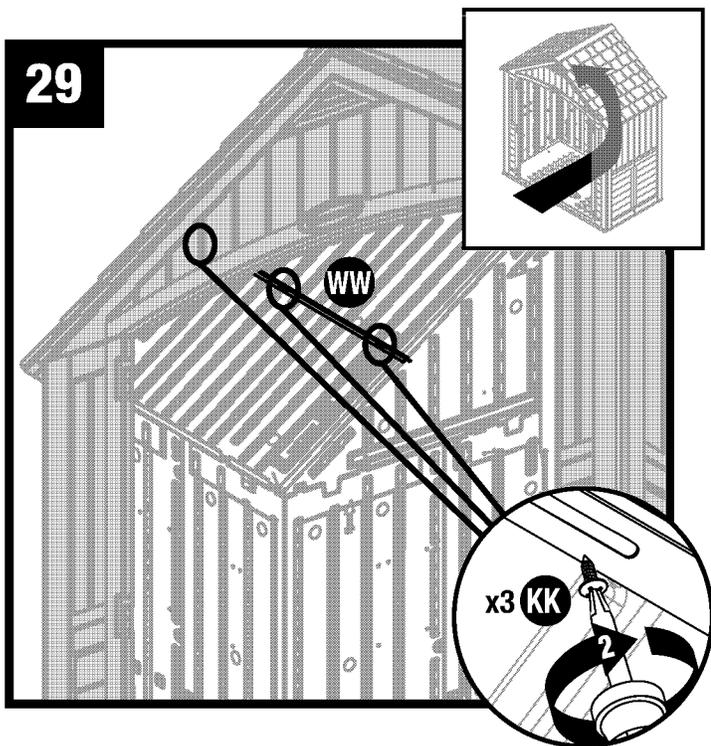
Ajuste la barra de soporte del techo al techo con dos tornillos (KK).
