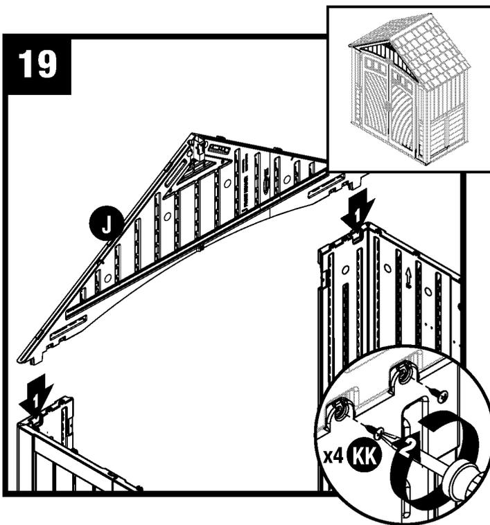
Coloque el dintel delantero (J) sobre la abertura de la puerta e instale las dos patas de apoyo sobresalientes en los receptáculos moldeados en las esquinas delanteras. Ajuste el dintel delantero con dos tornillos (KK) en cada esquina delantera.
