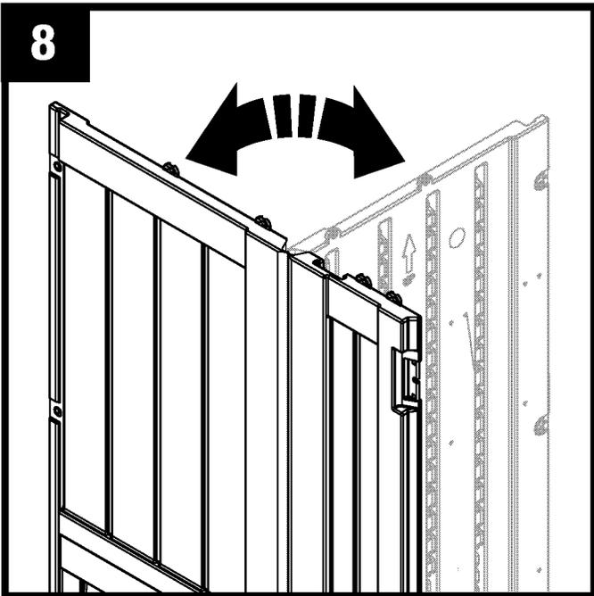
**Paso importante:** al instalar esquinas, doble las bisagras de las esquinas hacia delante y atrás varias veces. Esto ayudará a que el ángulo quede recto y asegurará la correcta colocación de los paneles restantes.
