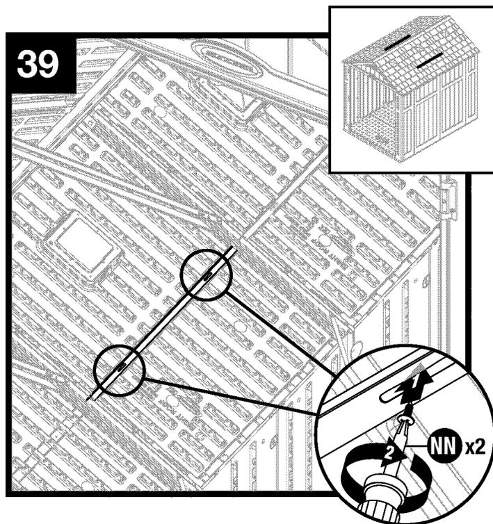
Soporte del techo seguro (SS) al panel del techo interior con dos tornillos (NN).
