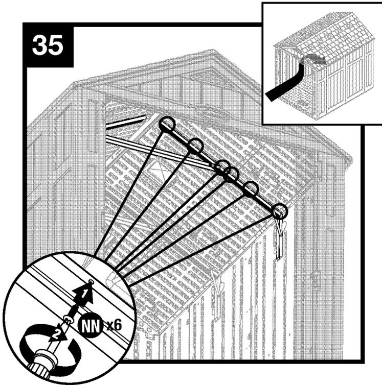
Ajuste el techo a la cabriada con seis tornillos (NN). Cada tornillo se ajustará en la brida del tornillo correspondiente en el techo.
