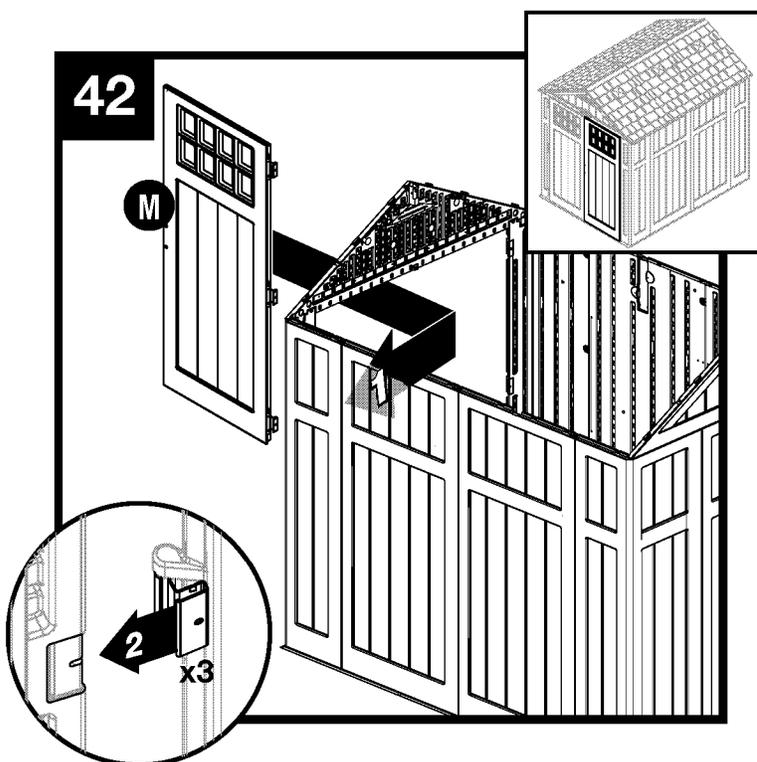
Con la bisagra de la puerta en la posición abierta, deslice la bisagra de la puerta sobre cada receptáculo de bisagra en el interior del panel frontal derecho.
