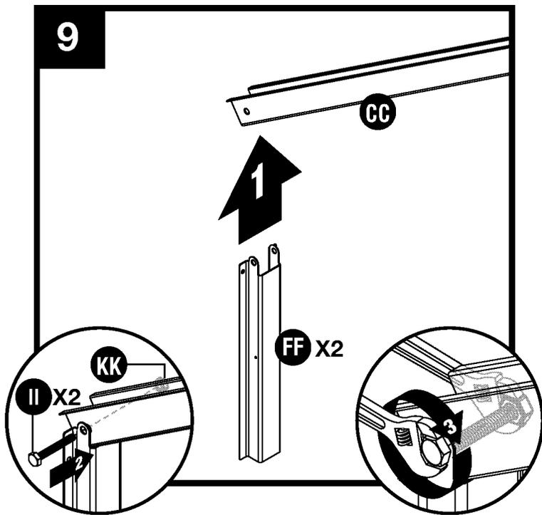
Coloque el amarre de la cabriada (FF) en la esquina del tramo izquierdo de la cabriada (CC). Sujétela con un amarre de la cabriada de 2 pulg. (II) y una tuerca (KK).
