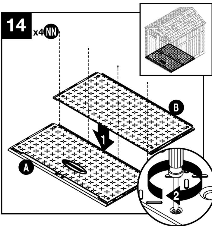
Alinee la lengüeta en el piso delantero (A) con la ranura en el piso central (B) y asegúrelo con cuatro tornillos (NN).
