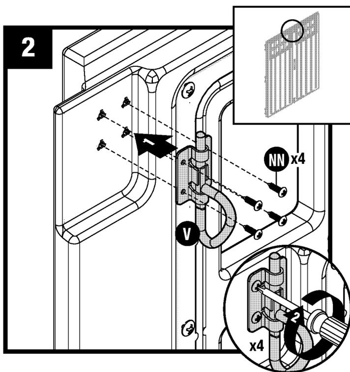
Sujete el perno deslizante del anillo en D (V) en el lado interior superior de la puerta izquierda haciendo pasar cuatro tornillos (NN) por los orificios provistos.
