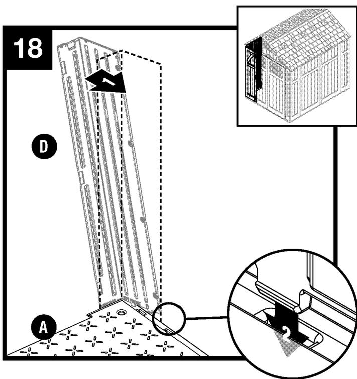
Incline el panel delantero izquierdo (D) nuevamente hacia la posición vertical y alinee las pestañas inferiores ubicadas en el lado derecho con las ranuras del piso.
