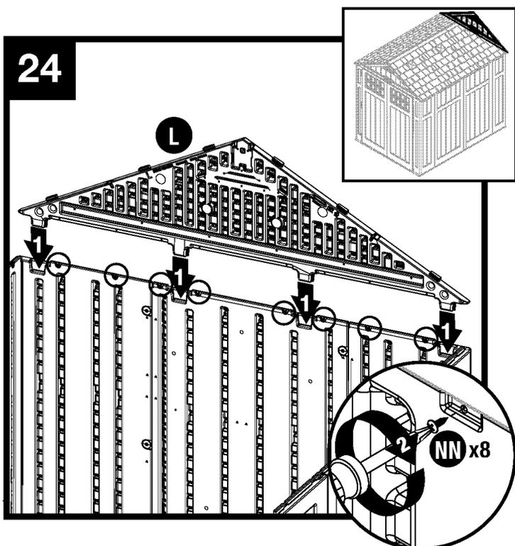
Coloque el dintel trasero (L) sobre las paredes traseras y encaje los cuatro soportes protuberantes dentro de los bolsillos moldeados en las paredes traseras. Asegure el dintel trasero con ocho tornillos (NN).
