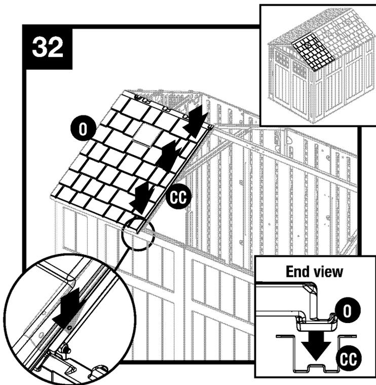
Coloque a presión el borde del techo derecho (O) dentro del canal del tramo de cabriada (CC).
