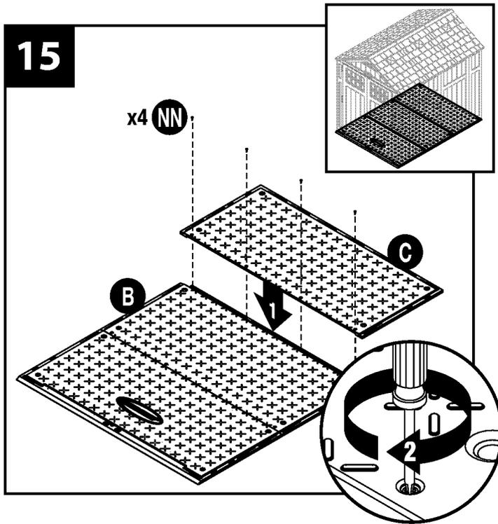
Alinee la pestaña en el lado inferior derecho del panel delantero piso trasero (C) y asegúrelo con cuatro tornillos (NN).
