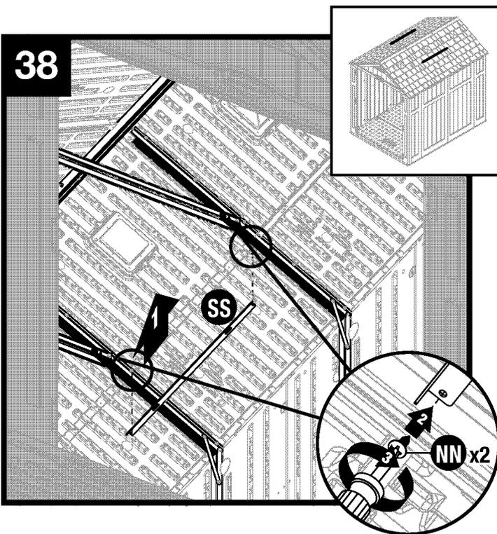
Adjuntar soporte del techo (SS) para truss piernas con dos tornillos (NN), cada lado.
