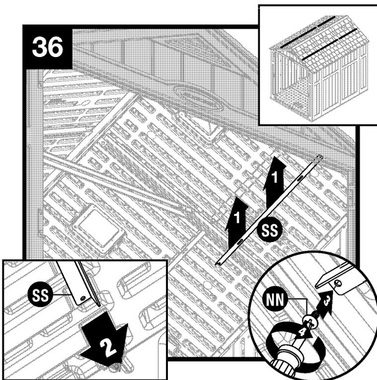
Levante el soporte del techo (SS) hasta su posición contra el techo. Deslice el soporte del techo (SS) en el dintel frontal. Asegure el soporte del techo (SS) debajo del tramo de la cabriada con un tornillo (NN).
