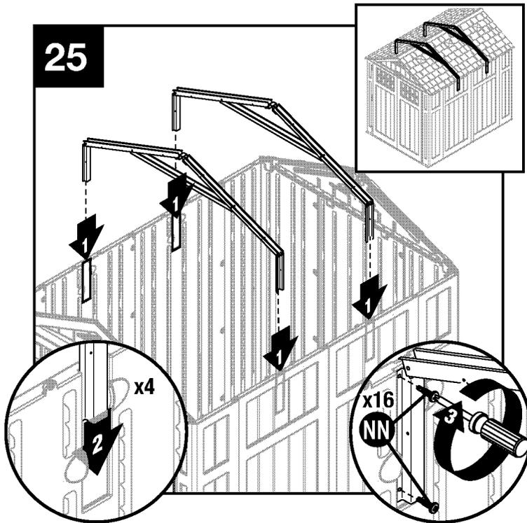
Deslice el ensamble de la cabriada con los soportes side adaptadores laterales en su lugar. Asegure con cuatro tornillos (NN) en cada soporte adaptador lateral.
