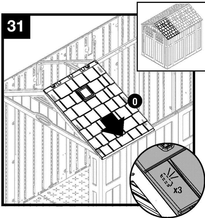
Deslice hacia abajo el techo derecho (O) hacia afuera de la caseta hasta que las lengüetas encajen en su lugar a presión.
