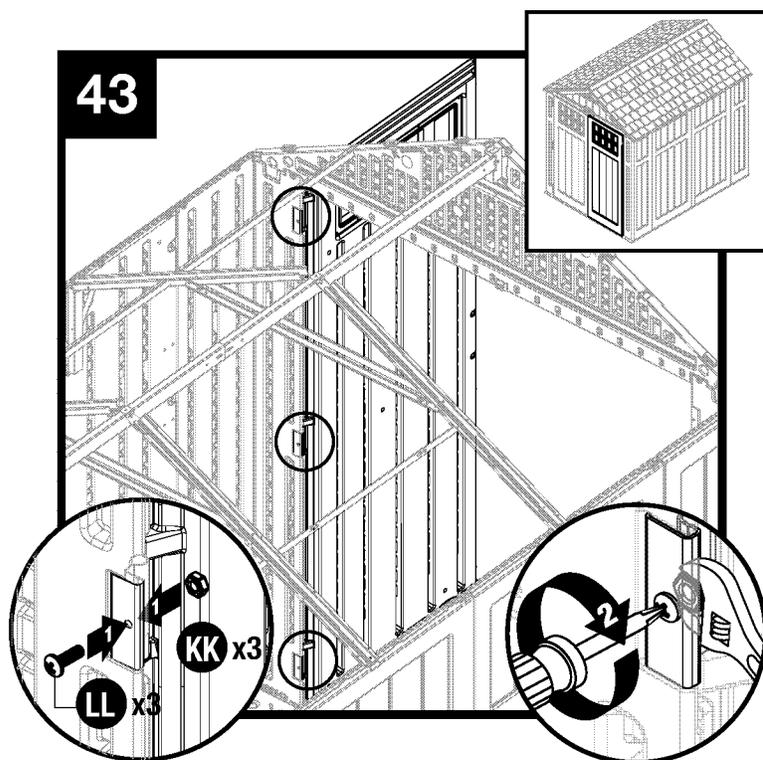
Asegure cada placa de bisagra de metal con un tornillo (LL) y una tuerca (KK).
