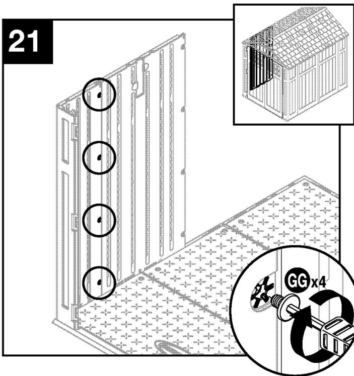
Ajuste el panel lateral con cuatro pernos Easy Bolt (GG), avanzando desde el piso hacia el techo. **NO** use una llave de torsión. Use la herramienta Easy Driver (KK) para pernos Easy Bolt y apriete manualmente. La cabeza del perno "Easy Bolt" quedará al ras cuando esté completamente asentado. **NO** apriete demasiado los pernos Easy Bolt.
