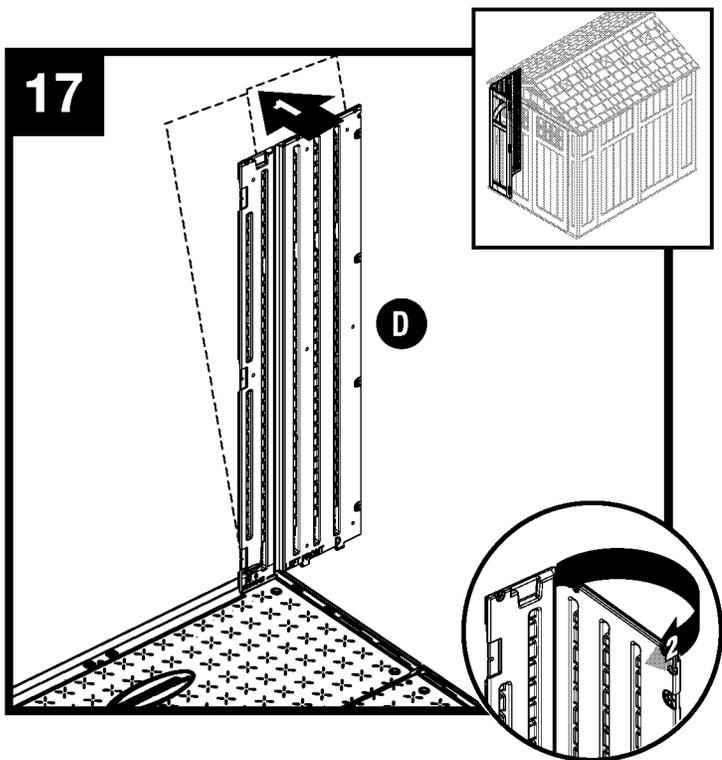
Incline levemente hacia fuera el panel delantero izquierdo (D) y doble la bisagra de la esquina.
