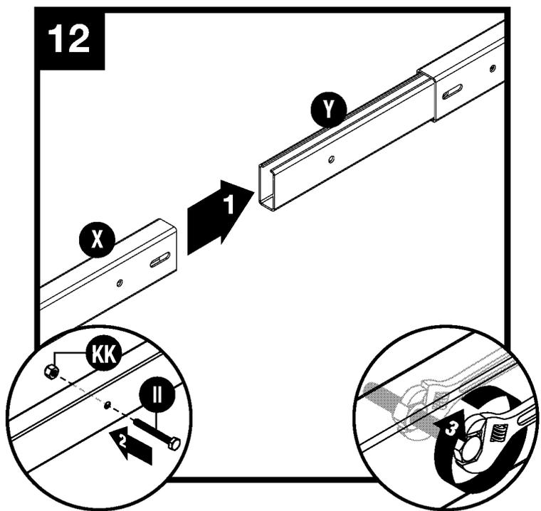
Inserte la viga cumbre (X) dentro de la pieza de unión de la viga cumbre (Y). Asegure con un perno hexagonal (II) y tuerca (KK).
