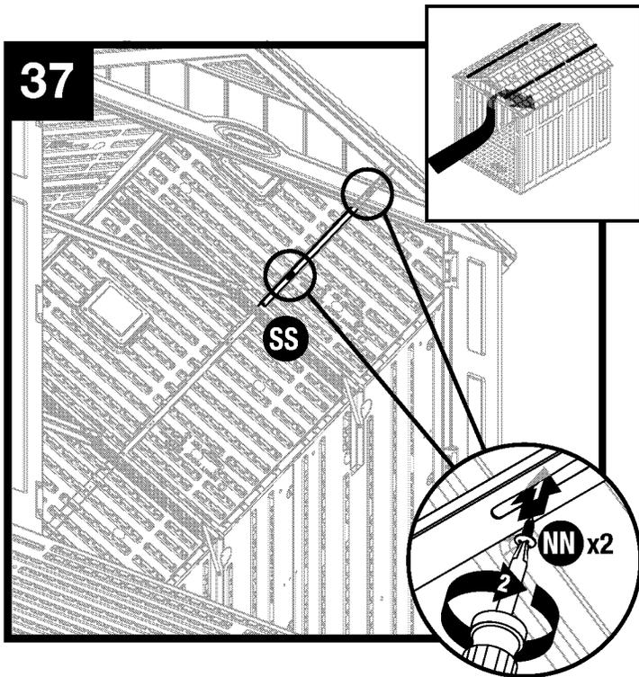
Ajuste el soporte (SS) del techo al techo con dos tornillos (NN).
