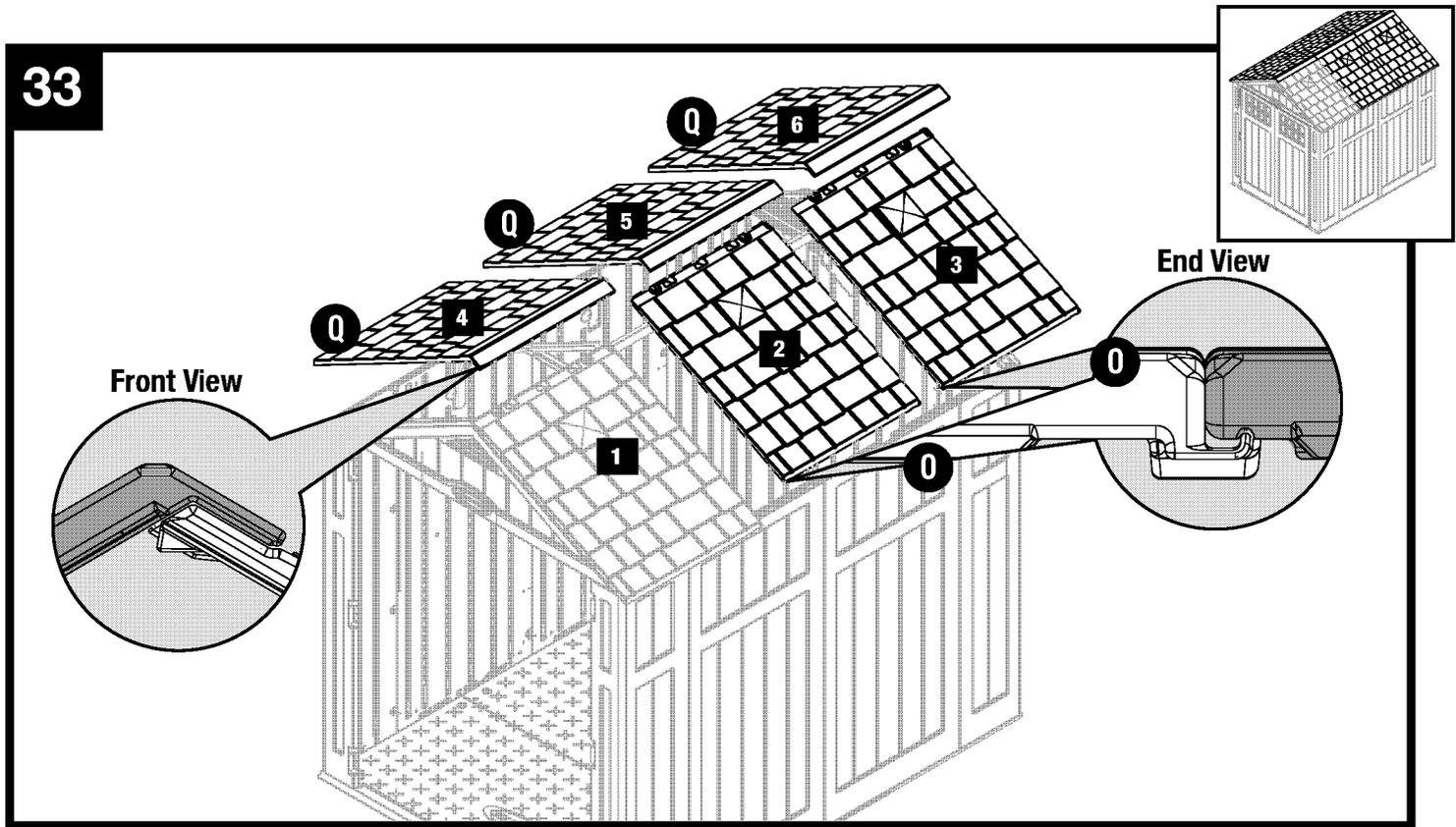
Repita los pasos 30 a 32 con los paneles de techo restantes. Instale los paneles en el orden que se muestra.
