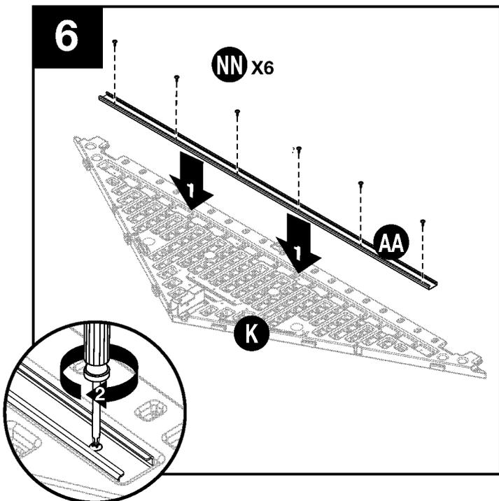
Coloque una viga del dintel (AA) dentro del receptáculo del dintel delantero (K). Asegure con seis tornillos (NN). **NO** apriete demasiado los tornillos. **Repita los pasos 4-6 para el dintel trasero encabezado (L).**
