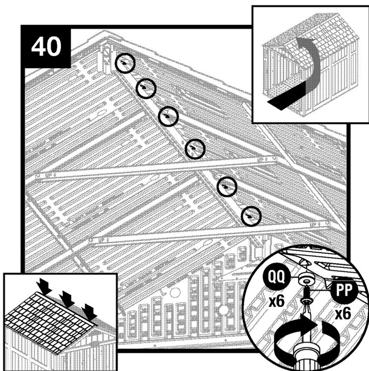
Empuje el techo hacia abajo desde el exterior. Desde el interior del cobertizo, ajuste los paneles del techo a lo largo de la viga del techo con seis arandelas de caucho (PP) y seis tornillos de cierre (QQ).
