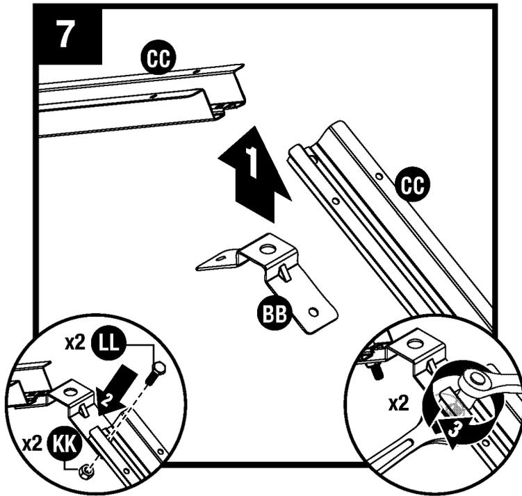
Ajuste el soporte de la cabriada (BB) en la esquina del tramo de la cabriada (CC) con un tornillo de cabeza hexagonal de 1 pulg. (LL) y una tuerca (KK).
