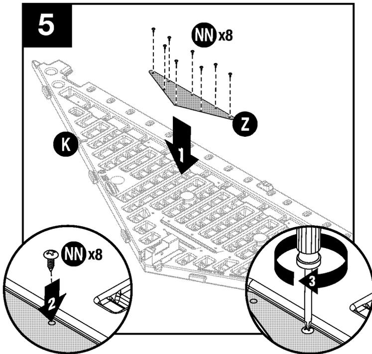
Apoye el dintel frontal (K) sobre el suelo con el lado que tiene las letras hacia arriba. Coloque la rejilla de ventilación (Z) dentro de la abertura trasera del dintel frontal (K). Asegure con ocho tornillos (NN) por la parte trasera del dintel. **NO** apriete demasiado los tornillos.
