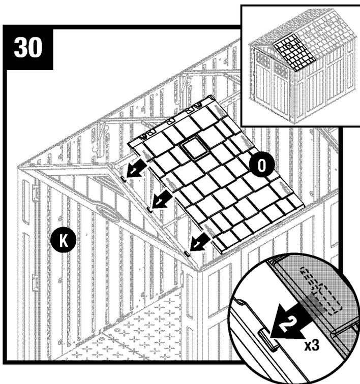
Coloque el techo derecho (O) directamente sobre las tres lengüetas del lado derecho del dintel frontal (K). Con las ranuras del techo derecho asentadas sobre las lengüetas del dintel, verifique el alineamiento en los tres lugares.
