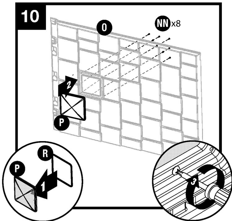
Coloque el empaque del tragaluz (R) en el tragaluz (P). Coloque el tragaluz (P) en el panel de techo derecho (O). Ajuste por debajo con ocho tornillos (NN). Asegúrese de que la varilla en las partes plásticas esté completamente asentada contra el empaque en el tragaluz. Repita este paso para el panel de techo del otro lado.
