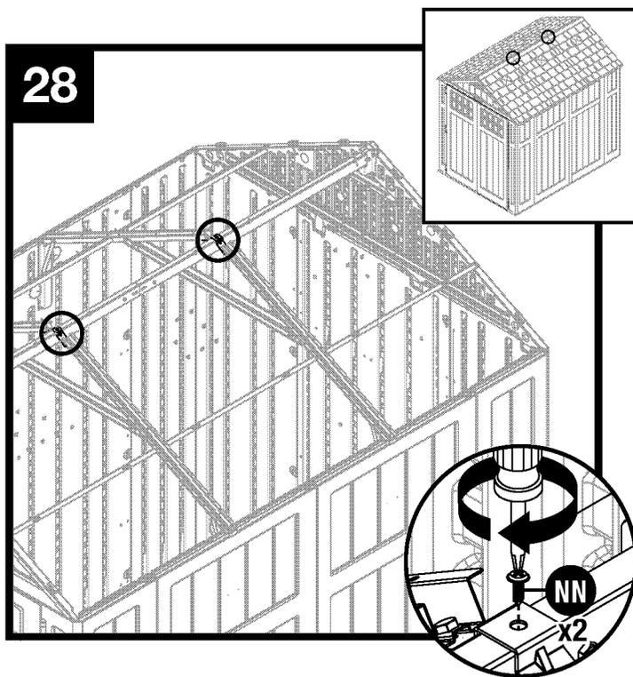
Acople el ensamblaje de la cabriada del techo a la viga (K) cumbre con un tornillo (NN) por cada ensamblaje de con el cabriada.
