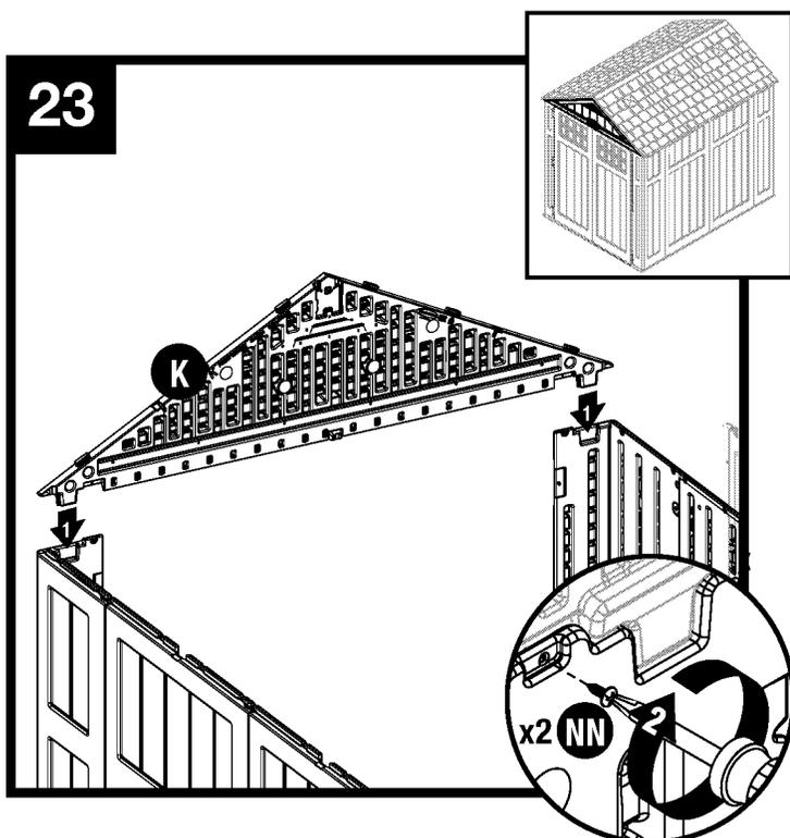
Coloque el dintel frontal (K) sobre la abertura de la puerta y encaje los cuatro soportes protuberantes dentro de los bolsillos moldeados en las esquinas frontales. Asegure el dintel con dos tornillos (NN).
