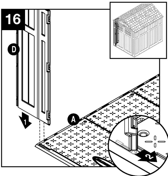
Alinee la pestaña en el lado inferior derecho del panel delantero izquierdo (D) con la ranura en el piso delantero (A). Introduzca el panel dentro de la ranura y trábelo haciendo deslizar el panel hacia la abertura de la puerta.
