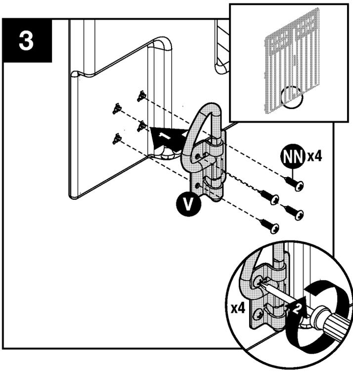
Sujete el perno deslizante del anillo en D (V) en el lado interior inferior de la puerta izquierda haciendo pasar cuatro tornillos (NN) por los orificios provistos.
