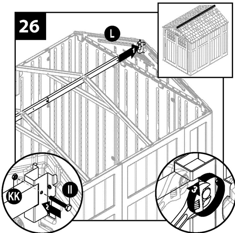
Eleve la viga cumbreira (X) y insértela dentro del dintel ridge trasero (L). Asegure con cuatro tornillos (II/KK). Repita el procedimiento con el dintel frontal (K).
