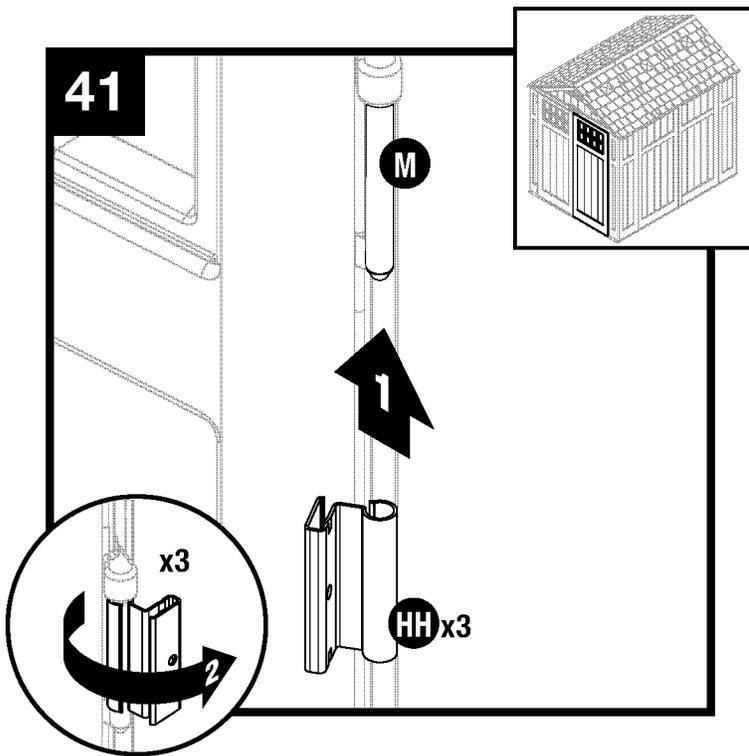
Coloque en forma vertical la puerta derecha (M) con los tres montajes para las bisagras orientados hacia la derecha. Deslice una bisagra de metal (HH) de la puerta sobre cada montaje para bisagra. Gire las bisagras de la puerta hacia la parte externa de la puerta. Repita para la puerta izquierda (N).
