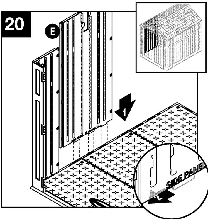
Alinee las pestañas en la parte inferior del panel lateral (E) con las ranuras a lo largo del piso trasero y delantero. Introduzca el panel dentro de las ranuras y trábelo haciendo deslizar el panel hacia la esquina delantera.
