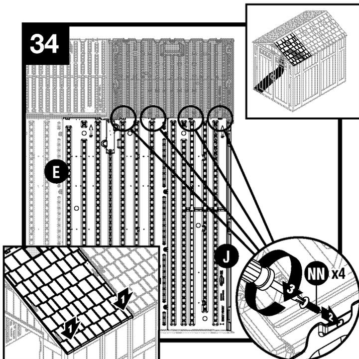
Tire hacia abajo de cada esquina inferior del techo desde el exterior. Desde adentro del cobertizo, ajuste las pestañas del panel de la ventana (E) y del panel de esquina delantero derecho (J) al panel de techo con cuatro tornillos (NN).
