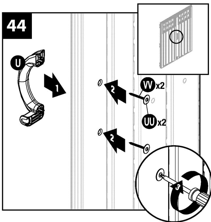
Instale la manija (U) en la puerta izquierda con dos tornillos (W) y la arandela (UU). Repita estos pasos para la puerta derecha.
