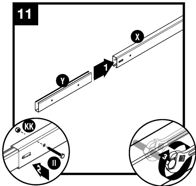
Coloque la pieza de unión de la viga cumbre (Y) dentro viga de la viga cumbre de 3 pies (X). Asegure con un perno hexagonal (II) y tuerca (KK).
