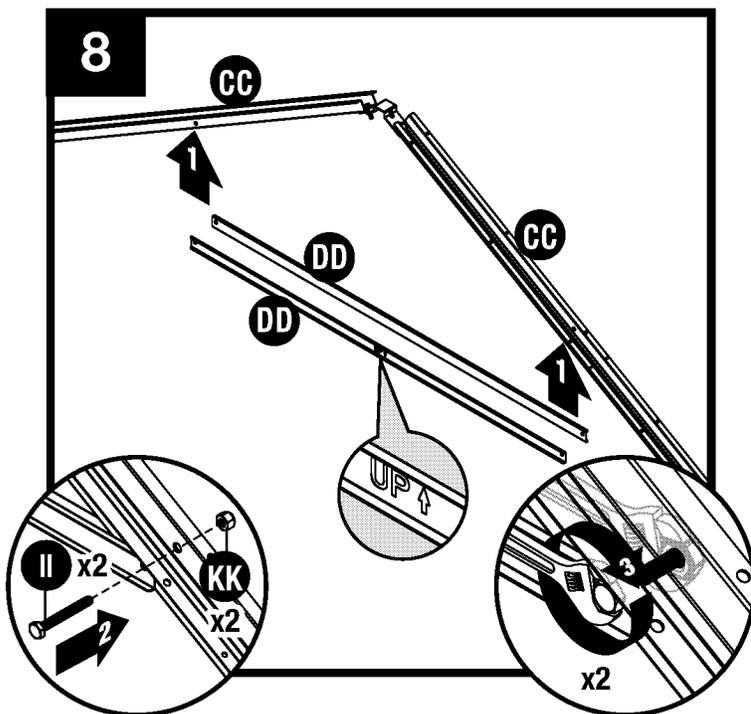
Ajuste la viga transversal de cabriada (DD) a dos tramos de la cabriada (CC) con dos tornillos de cabeza hexagonal (II) y dos tuercas (KK). Erija la cabriada y verifique que la viga transversal esté nivelada.
