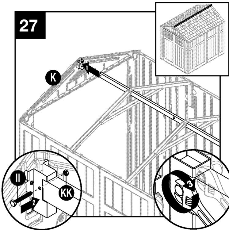
Eleve la viga cumbre (X) e insértela en el dintel trasero (K). Asegure con cuatro tornillos (II/KK).
