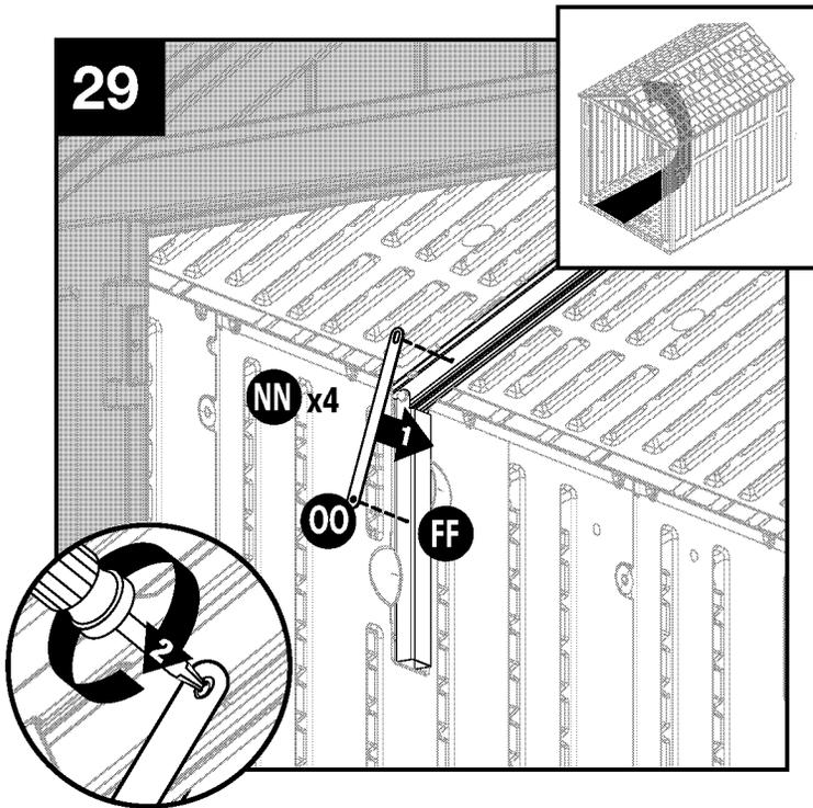
Acople el tirante de cabriada (OO) al soporte adaptador lateral (FF) con dos tornillos (NN). Repita el procedimiento con los tirantes de cabriada restantes.
