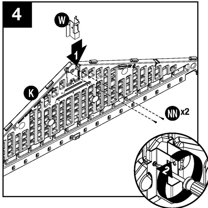
Deslice el soporte de la viga cumbrera del techo (W) debajo de las pestañas en el interior de la cima del dintel frontal (K) y asegúrelo con dos tornillos (NN). **NO** apriete demasiado los tornillos.
